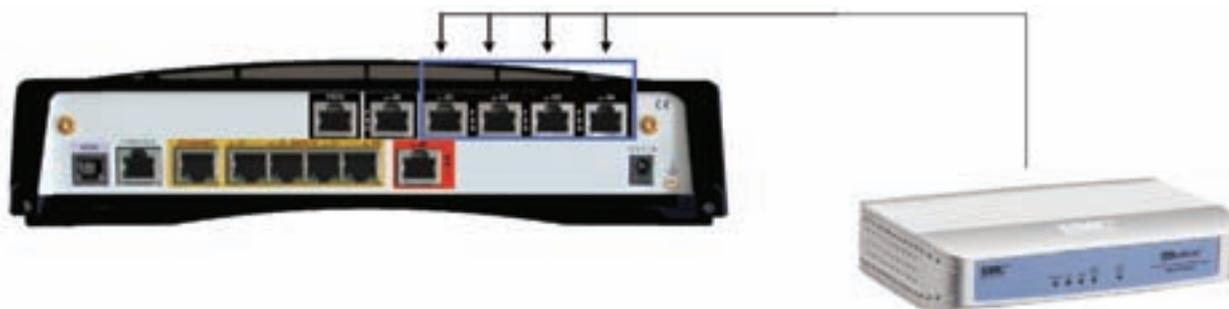
**NB :** si le terminal de données (alarme, paiement...) dispose d'une interface Ethernet il doit être connecté, au moyen d'un cordon RJ45, à une des prises Ethernet (E0 à E3) de la Business Livebox.
